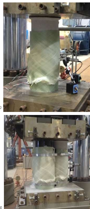
写真－3 破壊モード状況写真
