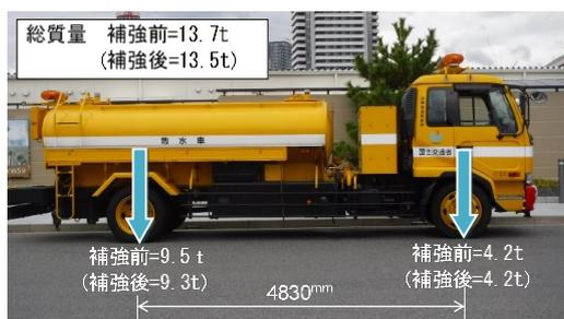
図 3 試験車 (散水車)
