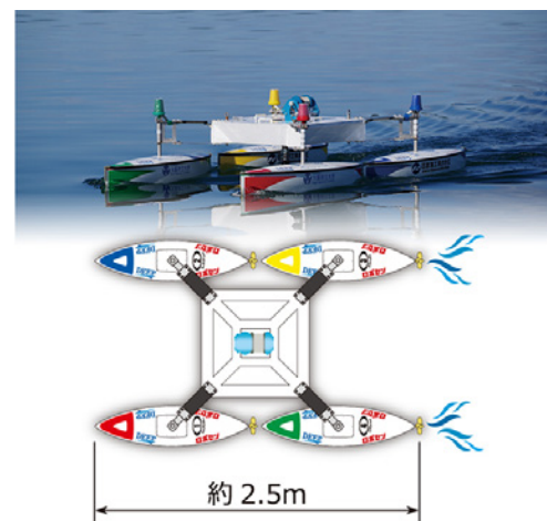
図-2 四胴船の移動形態
