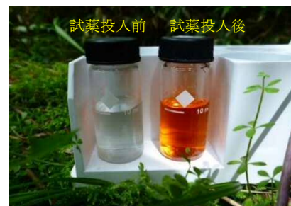
図-5 盛土部湧水の鉄分調査状況
