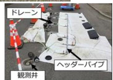
写真-1 実証試験装置の例
