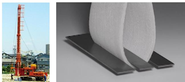
写真-2 圧密促進ドレーン打設機械とアンカー
