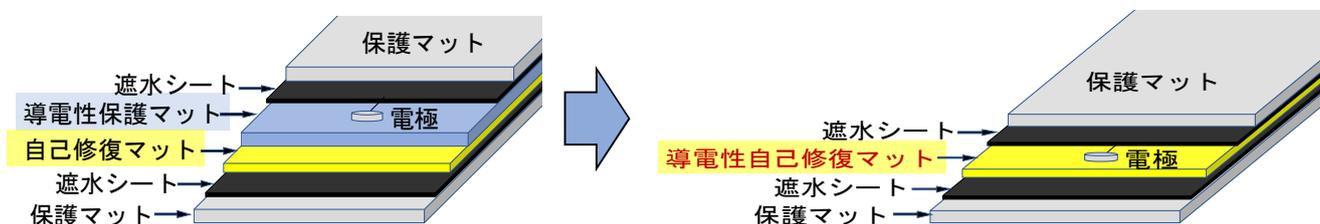
図-3 導電性自己修復マットを使用した場合の従来の遮水構造との比較
