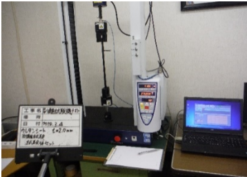
写真 3 剥離試験状況 (定速伸長型引張試験機)
