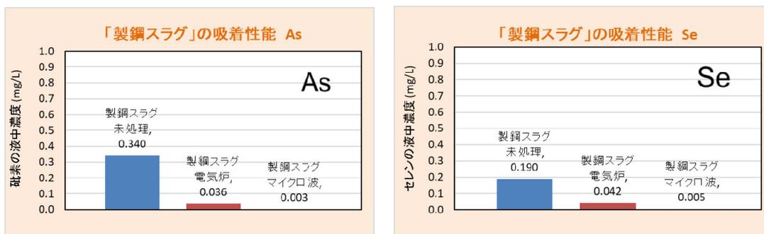
図-2 製鋼スラグの吸着試験結果
