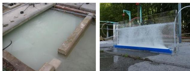
図-6 中和処理装置の実用と性能確認状況
