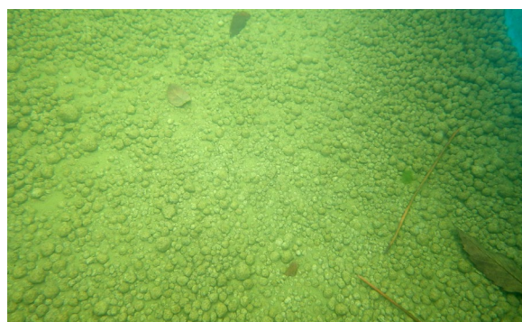
図-7 造粒固化物で覆砂した底質表面の状況 (実験120日間経過)
