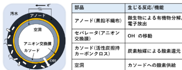
図1 MFCの構造および機能
