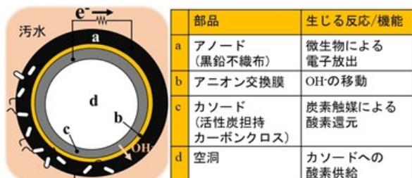
図-1 非白金触媒アニオン交換型 MFC の構成
