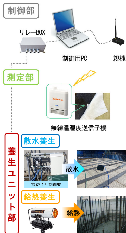
図-1 自動養生システム概要図
