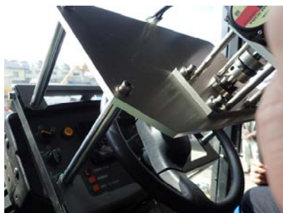
図-2 ハンドル制御機構の例
