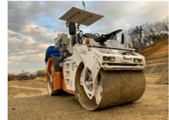
図-1 自動化振動ローラ
