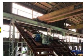
写真-4 ローリングアップ連続写真(サイクルタイム約60秒)
