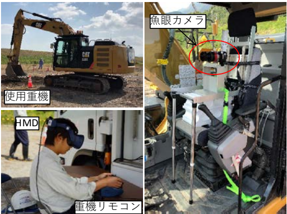
写真 1 使用重機と操縦機器
