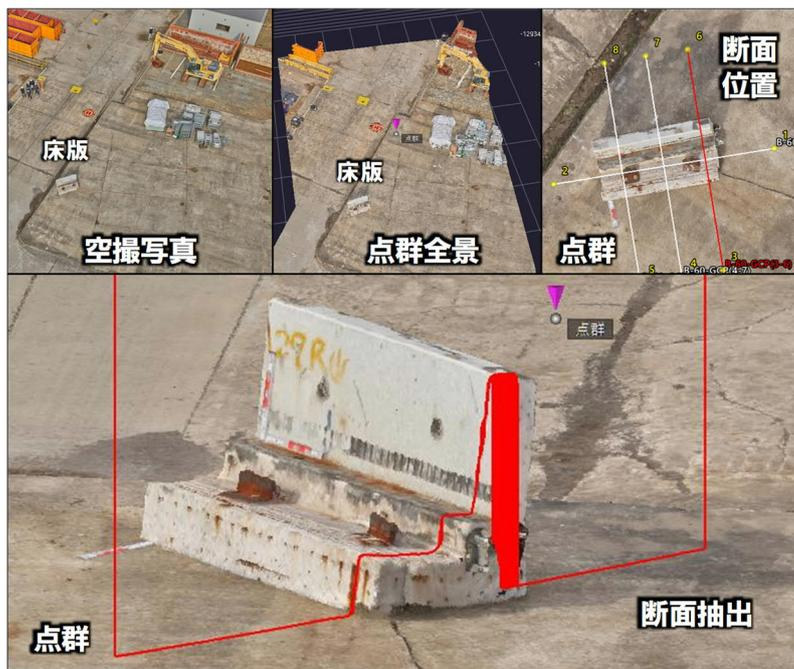
図-4 空撮写真及びSfMにより生成した点群
