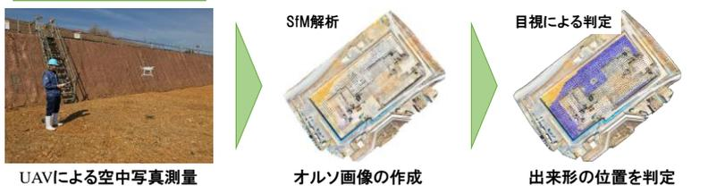
図-3 オルソ画像を用いた計測方法
