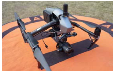
図-2 使用機種（PPK システム搭載）
