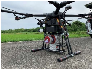
写真-1 VUX-1LR 搭載 UAV 写真-2 VLP-32 搭載 UAV
