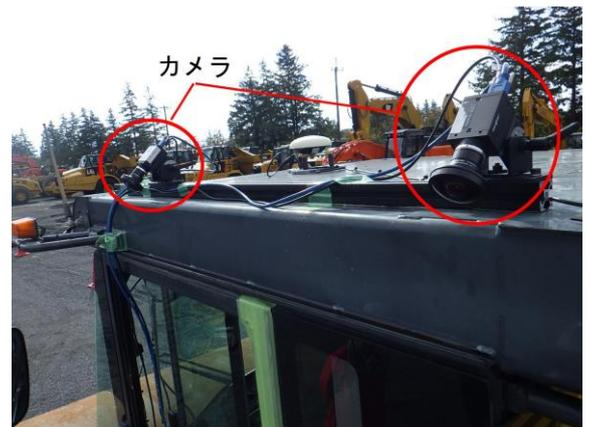
写真-1 カメラ設置状況
