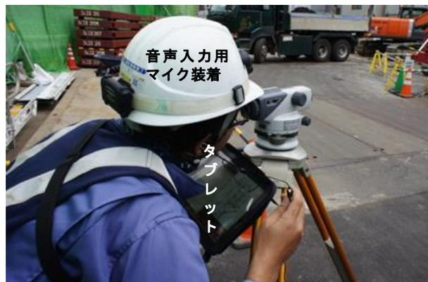
写真-1 VOISLによる水準測量実施状況
