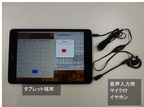
写真-2 タブレット端末と音声入力マイク付きイヤホン
