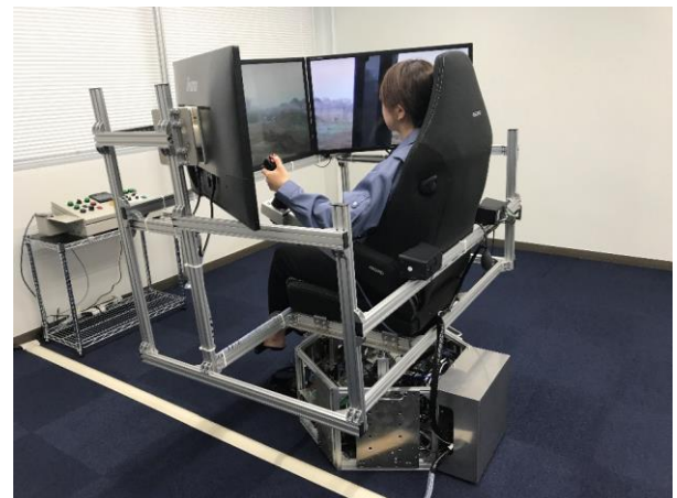
図 2 遠隔操作側機器構成(VR コクピット)
