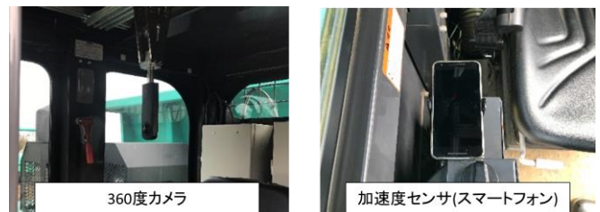
図 1 建設機械側機器構成
