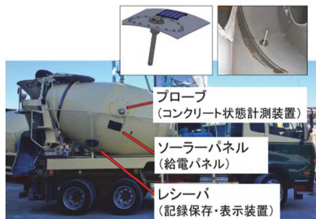
図-1 プローブによる計測技術の構成
