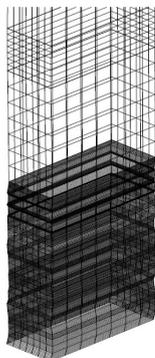
図-2 3次元モデルで出力した掘削溝の出来形
