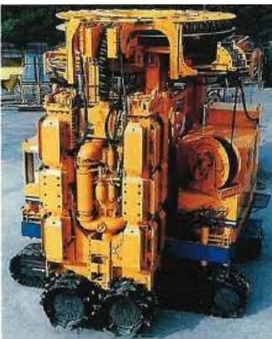
写真-1 連壁専用掘削機
