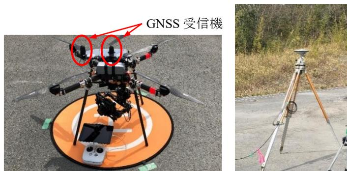
高性能 GNSS 搭載 UAV
