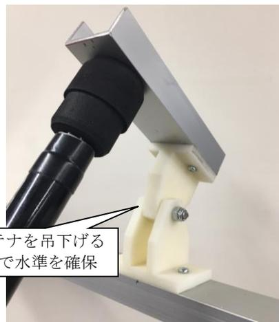
図-3：アンテナが天頂を向く機構
