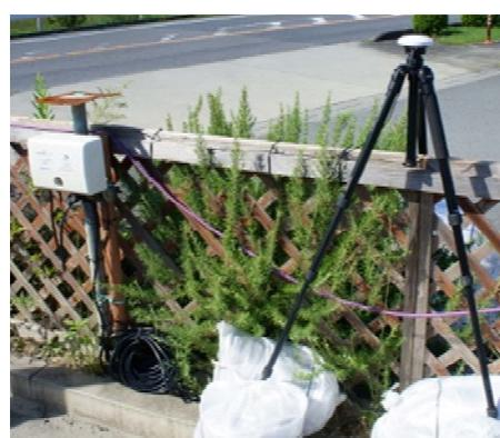
写真3 製作した測位機器
