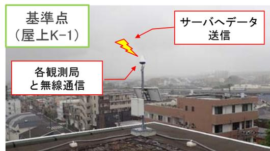
図-2. アンテナ設置状況
