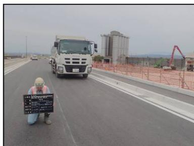
写真-4 開通前のたわみ量試験状況
