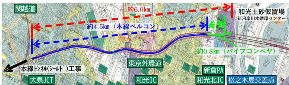
図-1 ベルトコンベヤ計画概要
