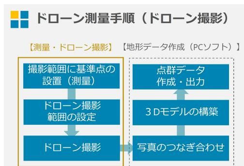
図-3 空撮～写真合成・点群作成フロー
