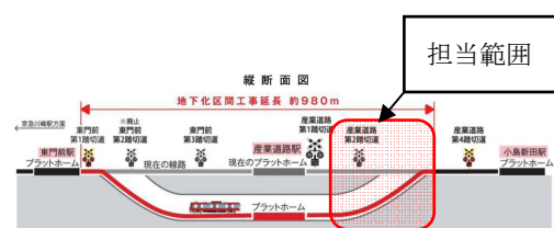
図-1 線路切替概略図(全体)
