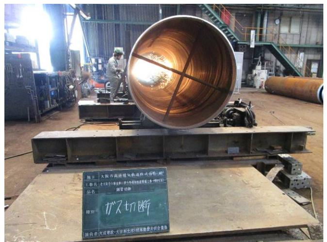
写真-2 鋼管杭切断状況
