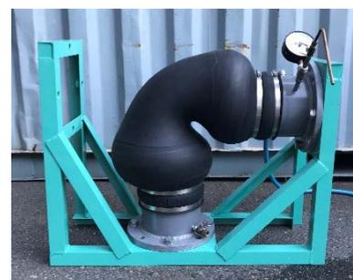
図-3 0.095MPa 圧力負荷状況
