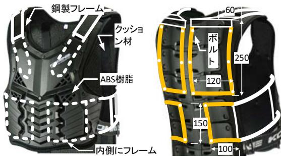
図2 試作した胸部保護具の構造(左:正面, 右:背面)
