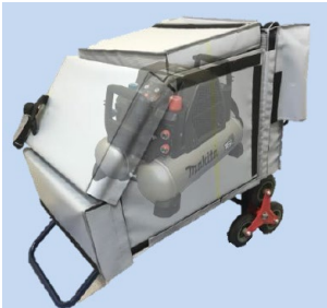
図-2 コンプレッサーの騒音低減策
