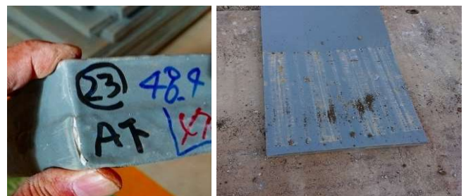
写真4 角部の損傷状況 (左) 敷鉄板無し走行：損傷なし (右)
