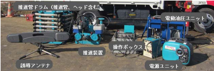
写真-1 開発した小口径カーブ配管工法の外観
