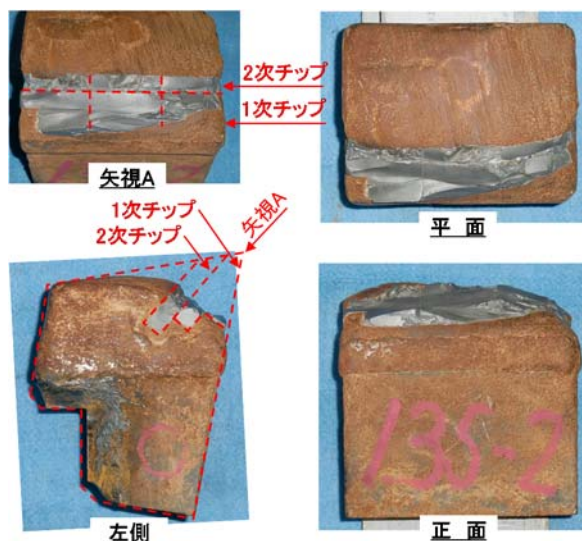
写真-1 ビット損傷状態-1
