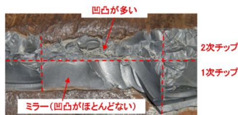
写真-3 超硬チップ損傷状態詳細
