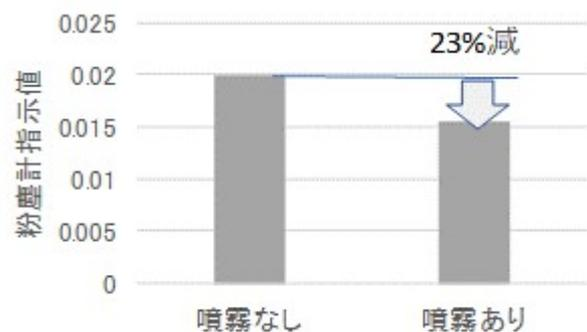
図-2 帯電ミストの粉塵除去効果(解砕ヤード)
