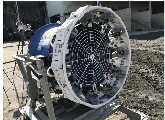
写真-1 ファン型の帯電ミスト発生装置
