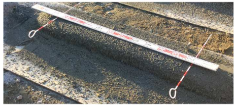
図-5 ノズル中心の軌跡と枠の形状
