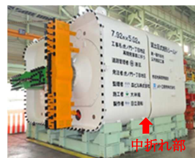
写真1 泥土圧シールド機
