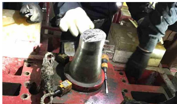
写真-2 把持軸破断状況
