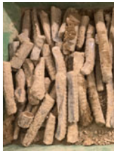
写真-1 回収鉄筋
