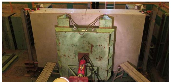
写真-3 継手曲げ試験状況
