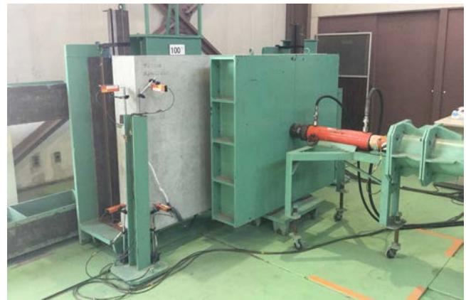
写真-2 継手曲げ試験状況
