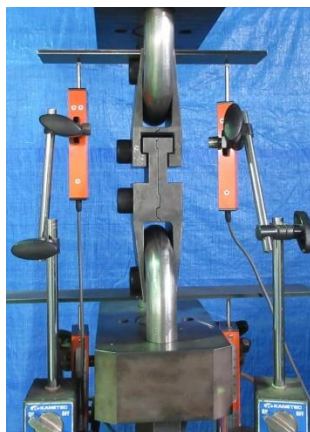
写真 2 金具単体引張試験
